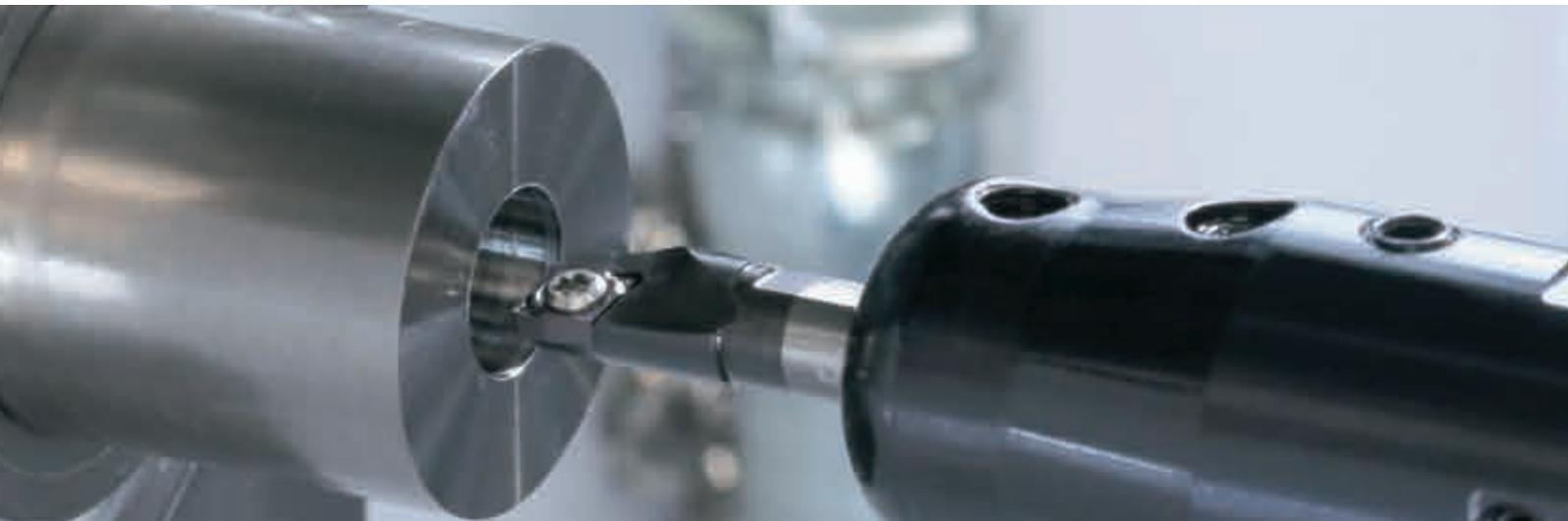
小内径加工の切りくず処理と低抵抗を両立
